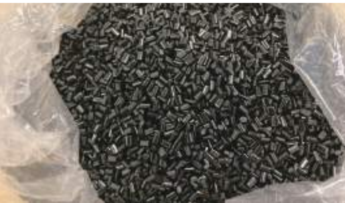
圖1 日本帝人公司開發回收酯漁網製成聚酯粒 資料來源：日本帝人公司官網，ITIS研究團隊整理(2026/2)。
